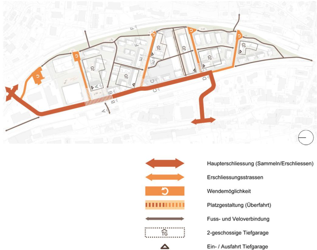
Abbildung 27: Erschliessungsschema (Darstellung Metron)
