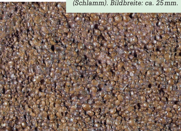
9 Bruchfläche des Eisenoolith-Gesteins im Bergwerk Herznach (Basis Oberes Erzlager). Die limonitischen Eisenooide sind etwa 0,5 bis 1 mm gross und zeigen unterschiedliche Formen. Grundmasse ist ein feiner eisenhaltiger Mikrit (Schlamm). Bildbreite: ca. 25 mm.
