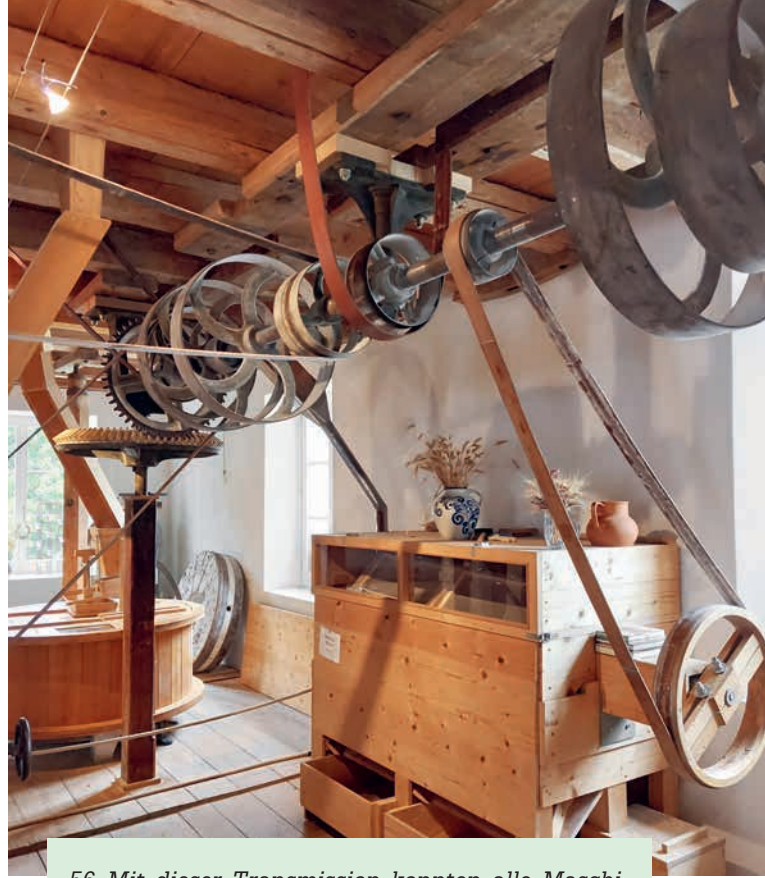
56 Mit dieser Transmission konnten alle Maschinen mittels lederner Riemen betrieben werden.
