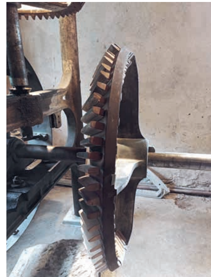
55 Die gusseisernen Zahnräder sind mit hölzernen Zähnen bewehrt. Das ist weniger laut und einfacher zu reparieren.
